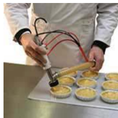
Pistola con manguera, para productos líquidos, semi-líquidos, suave, pesados y aireados
